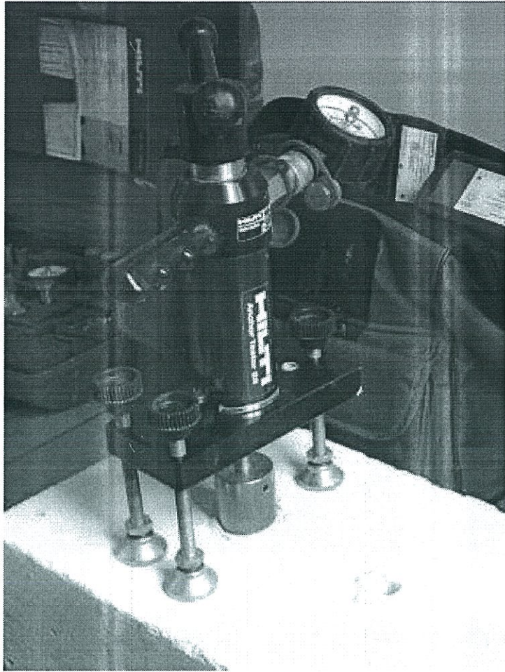
Фото 3 – Прибор для определения усилия выдёргивания анкеров Тестер HILTI NAT 28 Anchor testing system
